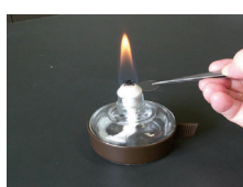
カバーガラスの端を曲げる
